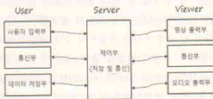
그림 5. 모바일과 영상 연동 시스템 구조
